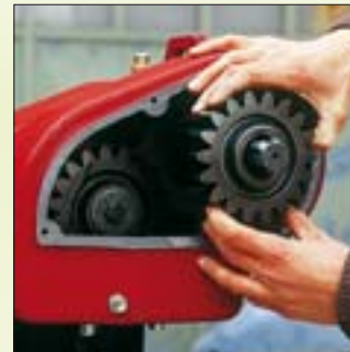
Riduttore a più velocità con cambio manuale. Multi-speed reducer with manual gearshift. Réducteur à plusieurs vitesses à changement manuel. Mehrgang-Untersetzungsgetriebe mit manueller Schaltung.
