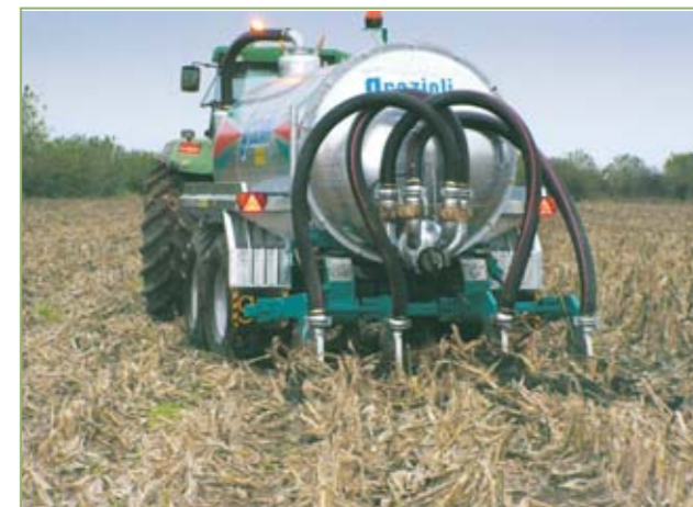
Interratore a 4 ancore in funzione. Profondità da 15 a 35 cm.
